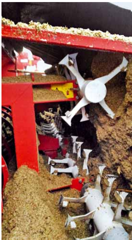
Particolare del sistema frontale con elementi separati per la disgregazione della massa vegetale umida
